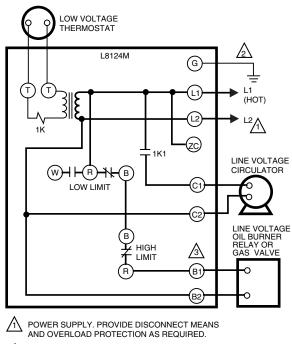
CONTROL CASE MUST BE CONNECTED TO EARTH GROUND. USE GROUNDING SCREW PROVIDED.
